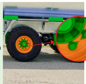
Doppen met pijlen om aan te geven of de wielbouten losgedraaid zijn
