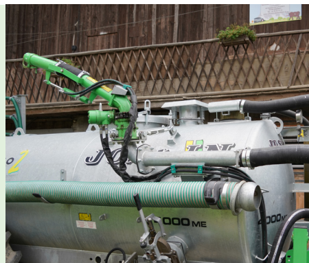
Draaibare Garda-kanon voor het besproeien van moeilijk bereikbare plekken. Besproeien door centrifugaalpomp met een druk van 6,5 bar en op een afstand van max. 50 m afhankelijk van de helling en windrichting.
