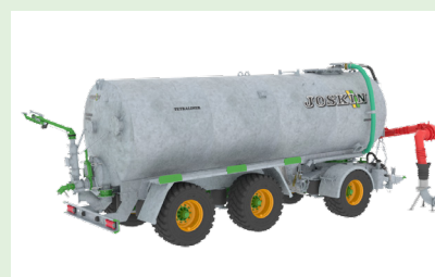
Tetraliner con cañón trasero y brazo de bombeo
