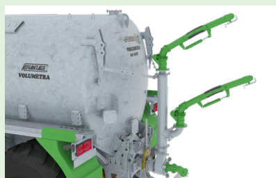
2 cañones traseros con turbo hidráulico.
