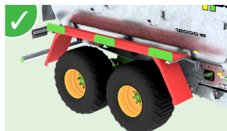
Guardabarros de acero galvanizado y bordes sintéticos
