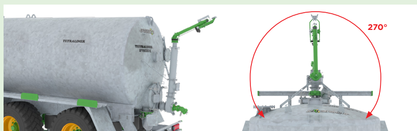
Cañón trasero (orientable manualmente o hidráulicamente) con turbo hidráulico.
