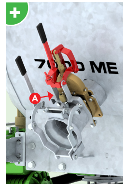
2 compuertas de aspiración laterales con entrada de aire automática A para vaciar las tuberías cuando la compuerta está cerrada.
