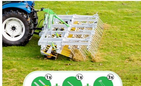
Scariflex R5S3 (6 uitvoeringen) Werkbreedte: 4,8 tot 10,8 m Hydraulische inklapfunctie
