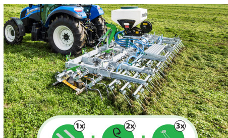
Scariflex R5S3 (6 uitvoeringen) Werkbreedte: 4,8 tot 10,8 m Hydraulische inklapfunctie
