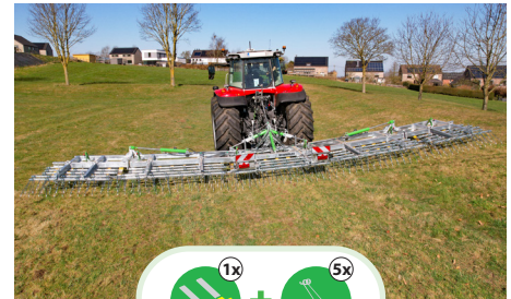
Scariflex R6S5 (6 uitvoeringen) Werkbreedte: 4,8 tot 10,8 m Hydraulische inklapfunctie
