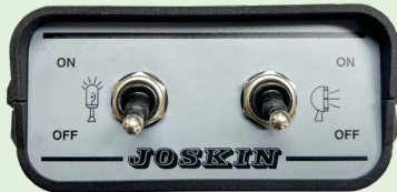
Bedieningskastje met één schakelaar voor de lampen en één voor de zwaailicht
