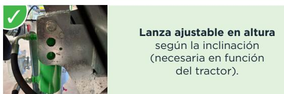
**Lanza ajustable en altura** según la inclinación (necesaria en función del tractor).
