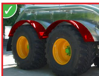
**Guardabarros termoplásticos** adaptados al empotramiento y a la anchura de las ruedas.
