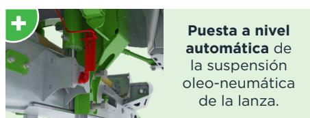
**Puesta a nivel automática** de la suspensión oleo-neumática de la lanza.
