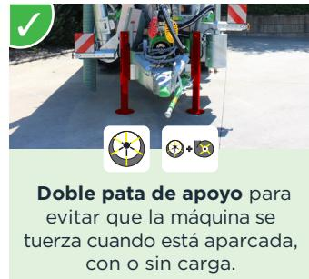
**Doble pata de apoyo** para evitar que la máquina se tuerza cuando está aparcada, con o sin carga.
