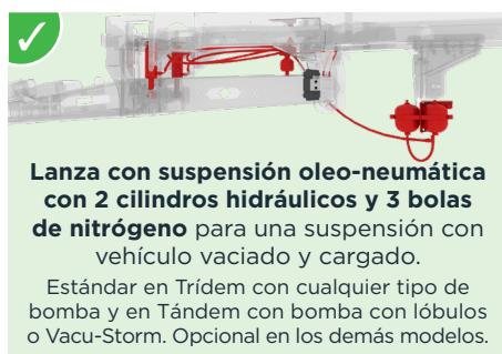
**Lanza con suspensión oleo-neumática con 2 cilindros hidráulicos y 3 bolas de nitrógeno** para una suspensión con vehículo vaciado y cargado.
