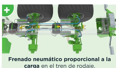
**Frenado neumático proporcional a la carga** en el tren de rodaje.
