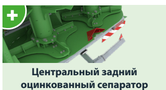
2 распределительных диска с 4 лопатками
