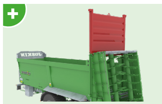
Оцинкованная дверь-гильотина , усиленная многочисленными ребрами жесткости. Двойное усиление по низу.
