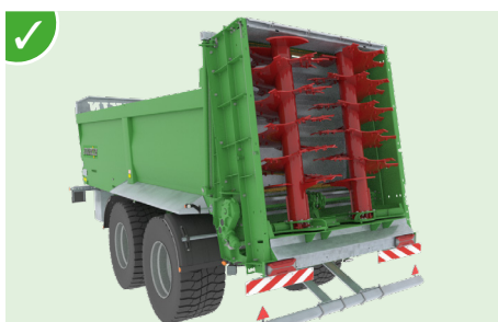
2 вертикальных вала диаметром Ø 1 100 мм со спиралью, приваренной к валу Ø 219 мм. Высота разбрасывающего вала: 1 770 мм (серия 11), 2 220 мм (серия 14) Высота под дверь-гильотину: 1 355 мм (серия 11), 1 700 мм (серия 14).
