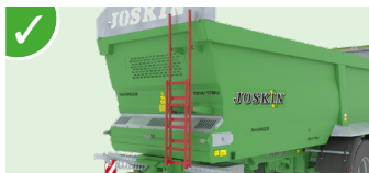
Składana drabinka zabezpieczona z przodu, dająca wgląd do wnętrza skrzyni.
