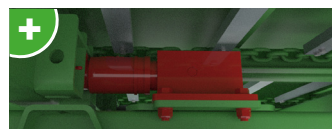
6-punktowe elektroniczne ważenie między ramą a skrzynią zapewnia optymalną dokładność.
