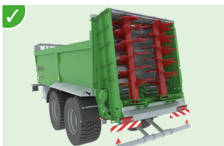
Adapter z dwoma pionowymi wałkami Ø 1100 mm ze spiralą ciągną na trzonie Ø 219 mm. Wysokość adaptera: 1770 mm (seria 11), 2220 mm (seria 14) Wysokość pod otwartą gilotyną: 1355 mm (seria 11), 1700 mm (seria 14).
