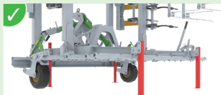
Pieds de dépose pour une bonne stabilité au décrochage.
