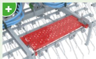
**Trittfläche** für einen sicheren Zugang zum Druckluft-Sägerät.
