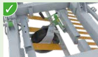
Ideale Positionierung der Tasträder für eine optimale Bodenanspassung.
