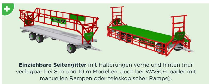
Einziehbare Seitengitter mit Halterungen vorne und hinten (nur verfügbar bei 8 m und 10 m Modellen, auch bei WAGO-Loader mit manuellen Rampen oder teleskopischer Rampe).
