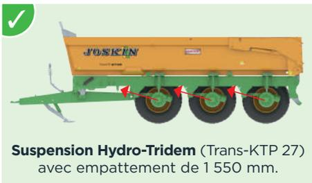
**Suspension Hydro-Tridem** (Trans-KTP 27) avec empattement de 1 550 mm.
