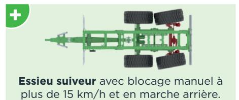
**Essieu suiveur** avec blocage manuel à plus de 15 km/h et en marche arrière.
