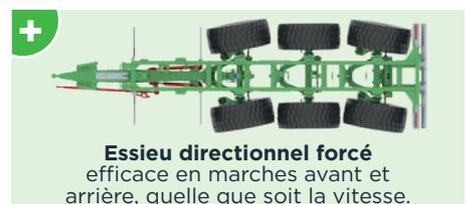
**Essieu directionnel forcé** efficace en marches avant et arrière, quelle que soit la vitesse.
