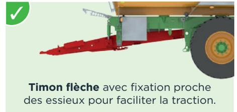
**Timon flèche** avec fixation proche des essieux pour faciliter la traction.
