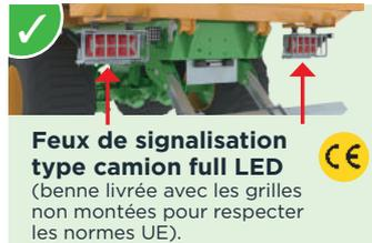
**Feux de signalisation type camion full LED** (benne livrée avec les grilles non montées pour respecter les normes UE).
