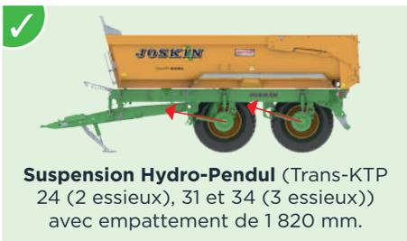
**Suspension Hydro-Pendul** (Trans-KTP 24 (2 essieux), 31 et 34 (3 essieux)) avec empattement de 1 820 mm.
