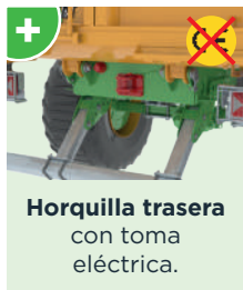
Tomas completas para iluminación, frenado y vuelco de un segundo remolque con horquilla trasera giratoria.
