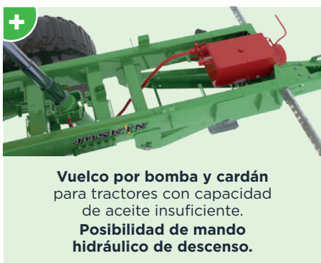
Vuelco a 61° por un cilindro telescópico montado en un cuadro de doble oscilación A y colocado en una posición avanzada en el bastidor.
