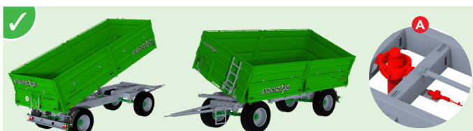
Funkcja trójstronnego wywrotu (do tyłu, na lewą i prawą stronę). (A) Siłownik wywrotu przymocowany do kołyski i kąt przechyłu bocznego ograniczany automatycznie przez zawór bezpieczeństwa.
