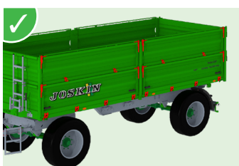
Verrouillage des ridelles par de nombreux crochets qui augmentent le contact de serrage entre la ridelle et la caisse, ce qui assure une parfaite étanchéité avec les joints.
