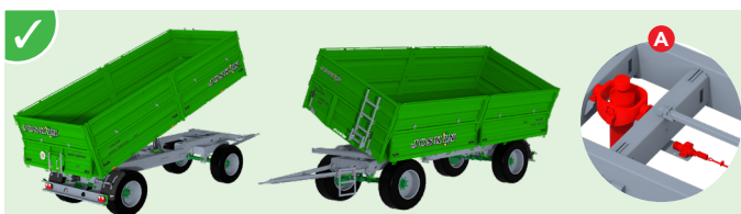
Fonction de bennage 3 côtés (arrière, gauche et droit). (A) Vérin de bennage fixé sur un cadre oscillant et angle de bennage latéral limité automatiquement grâce à une vanne parachute.
