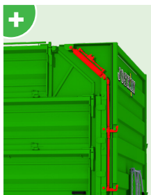
Double blocage de la porte arrière hydraulique avec joint d'étanchéité et tringlerie mécanique encastrée pour une bonne protection.
