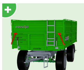
Ressorts de rappel avant pour faciliter la manipulation des ridelles (uniquement sur modèles 4525 et 5025).
