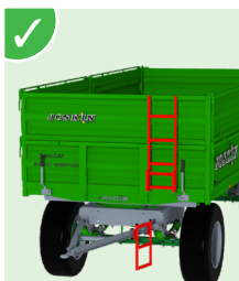
Échelle sur la face avant pour voir à l'intérieur de la caisse.
