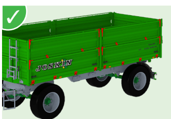
Bloqueo de los adrales por numerosos ganchos que aumentan el contacto de sujeción entre el adral y la caja, garantizando un sellado perfecto con las juntas.
