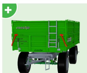
Resortes de retorno delanteros para facilitar la manipulación de los adrales (sólo en los modelos 4525 y 5025).
