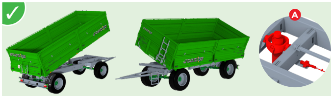
Dreiseitige Kippfunktion (hinten, links und rechts). (A) Kippzylinder, der an einem Schwingrahmen befestigt ist, und seitlicher Kippwinkel, der durch einen Auffangschieber automatisch begrenzt wird.
