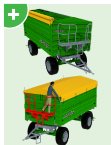
Manuell aufrollbare Plane + Plattform für optimale Sicherheit
