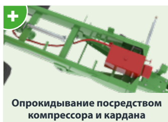
Опрокидывание под углом 59,6° посредством телескопического цилиндра, установленного на двойную подвижную раму, размещенного в передней части шасси.
