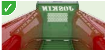
Schmäler, konischer und ausladender Kasten aus 4 mm Stahl (S420MC) mit verstärkten Oberkanten
