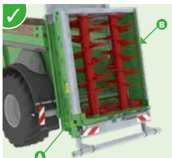
2 stehende Streuwalzen: \varnothing 1.010 mm durchgehende Spirale auf 219 mm Rohr; Drehzahl von 423 U/min mit einem Zapfwellenantrieb von 1.000 U/min.
