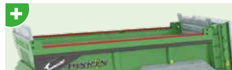
PVC-Schutz der 70 x 70 mm großen Kanten
