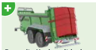
Doppelte Haube mit hydraulischen Randstreuflappen für Feldränder und Sicherheit auf der Straße
