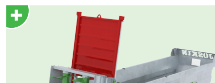
Puerta guillotina galvanizada de gran resistencia, acanalada y duplicada en la base.
