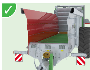
Caja estrecha , de chapa de 4 mm (S420MC) con pliegues de refuerzo en toda su longitud.
