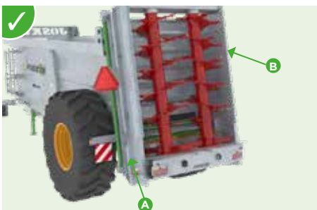
2 stehende Fräswalzen Ø 820 mm (S4008) oder 900 mm, Drehzahl 423 U/min, mit 10 mm dicker Spirale, die an Rohre mit Ø 140 mm (S4008) bzw. 190 mm bei den anderen Modellen geschweißt ist. (A) Schmierung oberhalb der Streuwalzen in Reichweite (B) Verzinkter Fadenschneider
