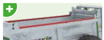
PVC-Schutz zum Schutz der oberen Ränder des Kastens.
