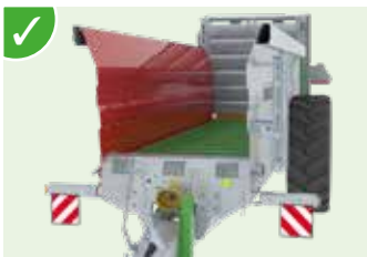
Schmaler Kasten , aus 4 mm Blech (S420MC) mit Verstärkungsbiegungen über die gesamte Länge.
