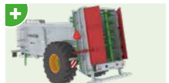
Große hydraulische Randstreuklappe (rechts, links oder beides).
