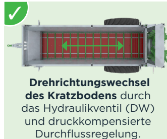
Rohrleisten geschlossen und geschweißt auf Schiffsketten Ø 14 mm (um Ablagerungen zu vermeiden) + gegossene Antriebsnüsse.
