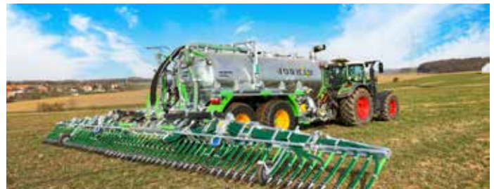
Pendislide START 3 Modelle erhältlich (Reihenabstand: 25 cm) • 9 m - 36 Ausgänge • 10,5 m - 42 Ausgänge • 12 m - 48 Ausgänge
