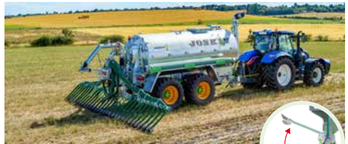
Pendislide BASIC 2 Modelle erhältlich (Reihenabstand: 25 cm) • 6 m - 24 Ausgänge • 7,5 m - 30 Ausgänge
