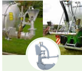
Möscha Verteiler Arbeitsbreite: 15 m (einfach) oder 18 m (doppelt)
