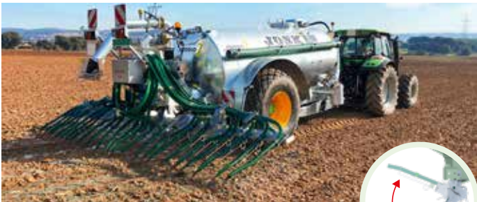
Penditwist BASIC 2 Modelle erhältlich (Reihenabstand: 25 cm) • 6 m - 24 Ausgänge • 7,5 m - 30 Ausgänge
