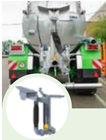
Eisele Verteiler Arbeitsbreite: 20 m
