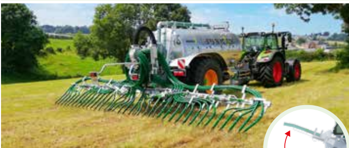
Penditwist START 3 Modelle erhältlich (Reihenabstand: 25 cm) • 9 m - 36 Ausgänge • 10,5 m - 42 Ausgänge • 12 m - 48 Ausgänge
