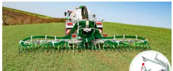
Pendislide START 3 Modelle erhältlich (Reihenabstand: 25 cm) • 9 m - 36 Ausgänge • 10,5 m - 42 Ausgänge • 12 m - 48 Ausgänge
