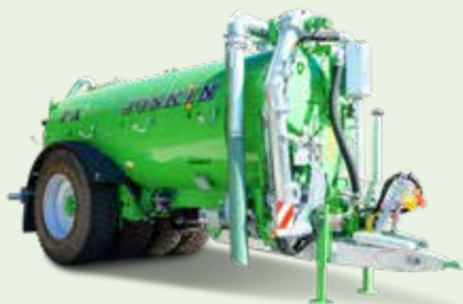
Tetrax2 4 grandes roues alignées pour éviter le compactage des sols
