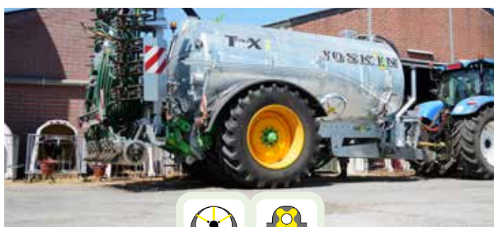
Tetrax2 (4 modèles) Capacité : 10 755 à 16 400 l 4 roues de grand diamètre sur la même ligne d'essieux
