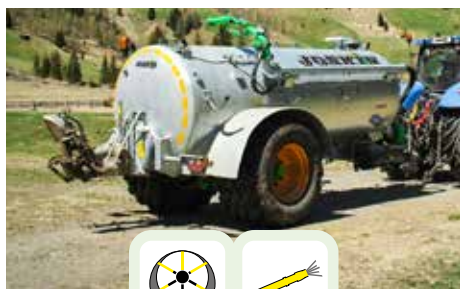
Alpina2 (4 modèles) Capacité : 6 031 à 8 043 l Simple essieu (conception surbaissée)
