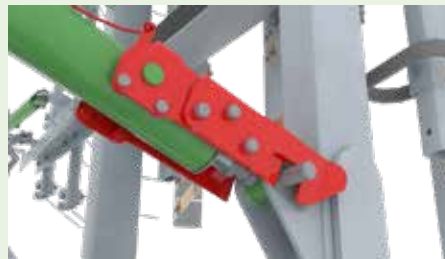
Hydraulische und mechanische Blockierung der Flügel für maximale Sicherheit auf der Straße.
