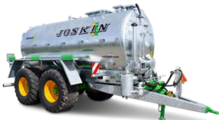
Modulo2 (17 modellen) "Oneindig" aanpasbare mengmesttank Inhoud: 2 529 tot 20 185 l Enkel- of dubbelasser Pompen:
