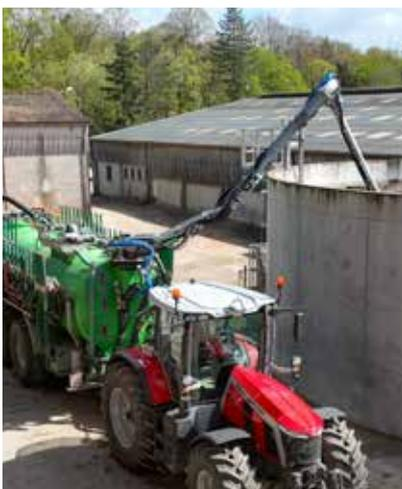
Der Vorteil des an der Vorderseite des Behälters befestigten Ansaugrüssels ist, dass er dem Fahrer bei der Handhabung des Güllefasss eine **ausgezeichnete Sicht** bietet. Er kann beim Pumpen in einen Container oder eine oberirdische Grube einen maximalen Hubwinkel und beim Pumpen in eine unterirdische Grube einen maximalen Tauchwinkel erreichen.
