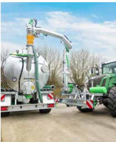
Der selbsttragende Ansaugarm am Frontkraftheber des Schleppers ermöglicht **weniger Manöver** und lässt das Gestänge beim Tanken ausgeklappt. Neben dieser erheblichen Zeitersparnis ist der beste Vorteil dieses Systems zweifellos die **Sichtbarkeit** durch den Seitenversatz nach rechts und das scherenförmige Einklappen vor den Vorderrädern des Schleppers.
