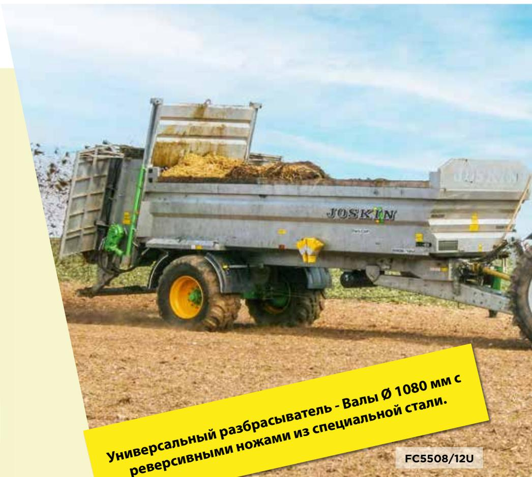
Универсальный разбрасыватель - Валы Ø 1080 мм с реверсивными ножами из специальной стали.
