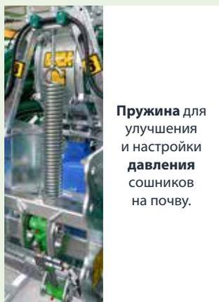
Пружина для улучшения и настройки давления сошников на почву.
