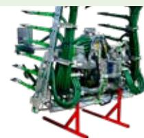
**2 опоры** обеспечивают быстрое отцепление и устойчивость штанги при хранении.
