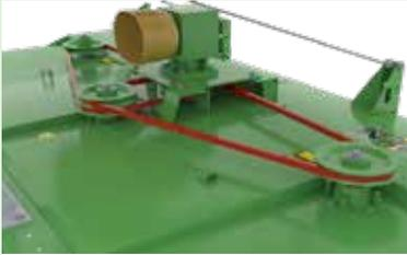
**Transmisión por correas** para evitar cualquier daño mecánico a la máquina (TR).
