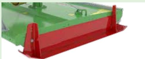
**Patines galvanizados** de 144 mm de ancho en toda la profundidad de las máquinas. Altura de corte ajustable de 6 a 8 posiciones, según el modelo.
