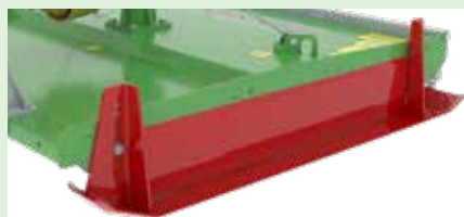
Patins galvanisés de 144 mm de largeur sur toute la profondeur des machines. Hauteur de coupe réglable sur 6 à 8 positions, selon le modèle.
