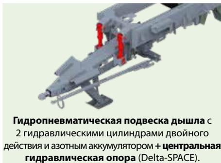
Гидропневматическая подвеска дышла с 2 гидравлическими цилиндрами двойного действия и азотным аккумулятором + центральная гидравлическая опора (Delta-SPACE).
