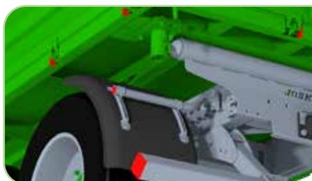
Крышки из пластика на оцинкованных элементах для предотвращения накопления продукта.
