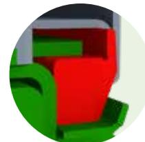
Резиновый уплотнитель по всему периметру кузова, обеспечивающий оптимальную герметичность.
