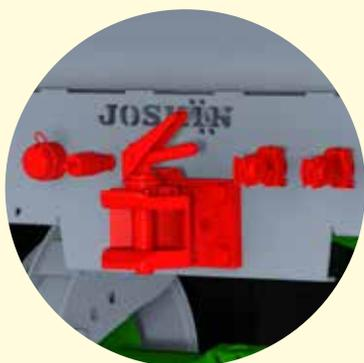
Розетки для освещения, торможения и опрокидывания второго прицепа с задним поворотным крюком.
