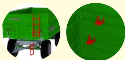
Лестница на фронтальной стенке и оцинкованные ступени внутри кузова.
