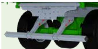
Многопозиционное защитное устройство, регулируемое по высоте
