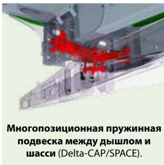
Многопозиционная пружинная подвеска между дышлом и шасси (Delta-CAP/SPACE).
