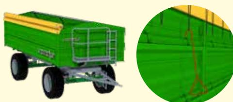
Тент с ручным сматыванием + крюк для легкого закрепления груза, даже высоких ящиков.
