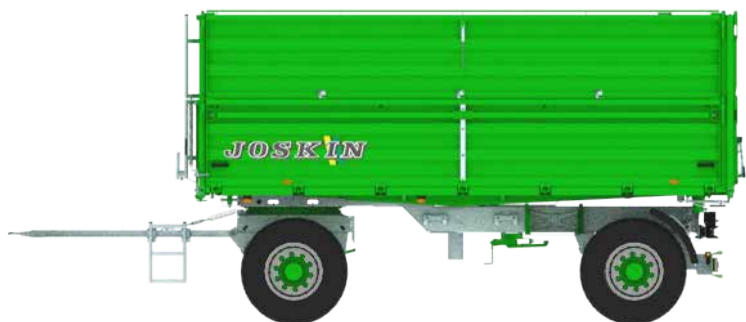
W modelu Tetra-CAP/SPACE: zawieszenie na resorach parabolicznych.
