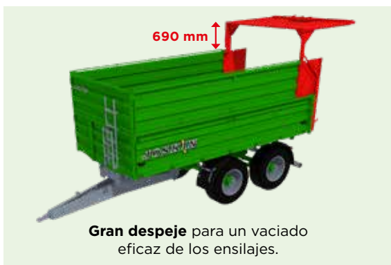
Puerta trasera hidráulica con junta de hermeticidad y articulación mecánica de bloqueo empotrada.
