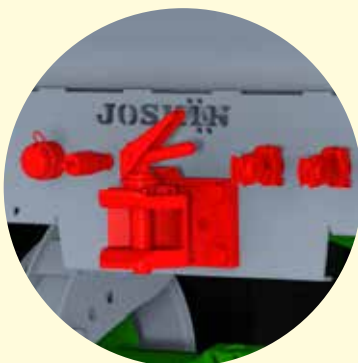
Tomas completas para iluminación, frenado y vuelco de un segundo remolque con horquilla trasera giratoria.
