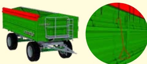
Toldo con enrollamiento manual + gancho para facilitar la sujeción, incluso con cajas más altas.
