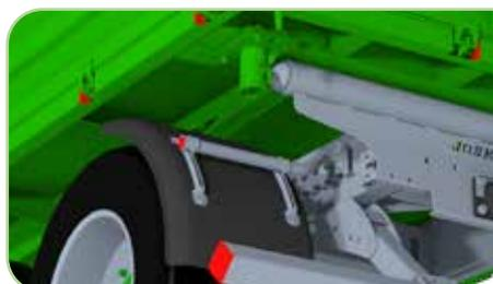
Orificios galvanizados con tapones de plástico para protegerlos de la acumulación de material.
