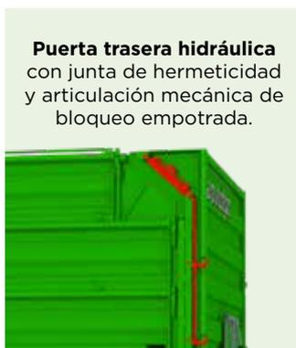
**Puerta trasera hidráulica** con junta de hermeticidad y articulación mecánica de bloqueo empotrada.
