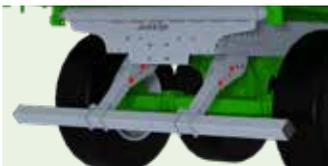
Parachoques trasero multiposición ajustable en altura (modelos Delta).
