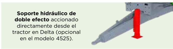
**Soporte hidráulico de doble efecto** accionado directamente desde el tractor en Delta (opcional en el modelo 4525).
