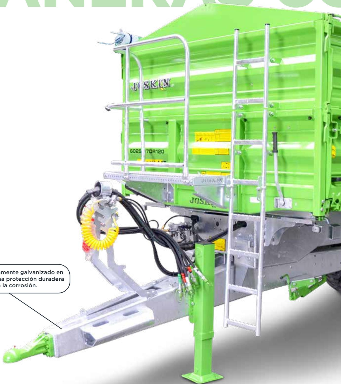
Bastidor enteramente galvanizado en caliente para una protección duradera contra la corrosión.
