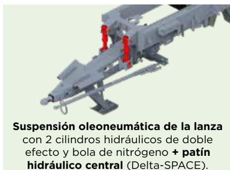
**Suspensión oleoneumática de la lanza** con 2 cilindros hidráulicos de doble efecto y bola de nitrógeno + **patín hidráulico central** (Delta-SPACE).
