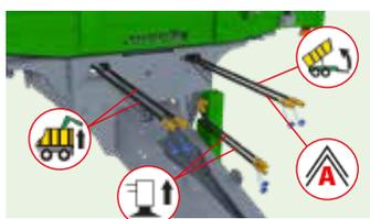
**Mangueras hidráulicas numeradas** para facilitar la gestión de los recambios + adhesivos que indican las funciones.
