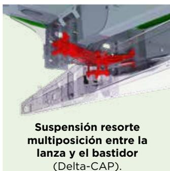
**Suspensión resorte multiposición entre la lanza y el bastidor** (Delta-CAP).
