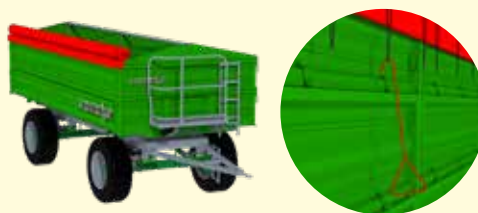
Manuell aufrollbare Plane + Haken , um sie auch bei höheren Seitenwänden leicht zu befestigen
