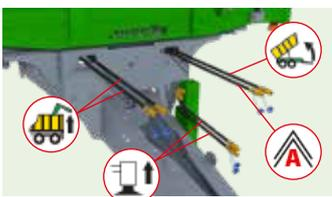
**Nummerierte Hydraulikschläuche** zur Erleichterung der Ersatzteilverwaltung + Aufkleber mit Angabe der Funktionen
