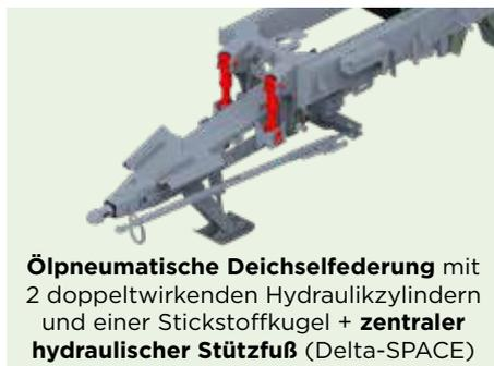
**Ölpneumatische Deichselfederung** mit 2 doppelwirkenden Hydraulikzylindern und einer Stickstoffkugel + **zentraler hydraulischer Stützfuß** (Delta-SPACE)
