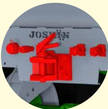
**Vollständige Anschlüsse** für die Beleuchtung, das Bremssystem und zum Abkippen eines zweiten Anhängers **mit optionalem automatischem Zugmaul.**
