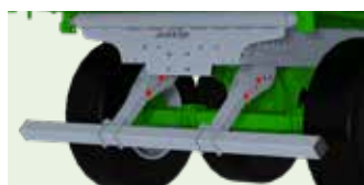
Pare-chocs arrière multiposition réglable en hauteur (modèles Delta).
