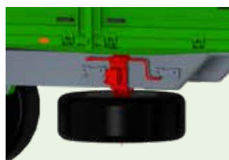
Treuil pour roue de secours (Tetra-CAP/SPACE).
