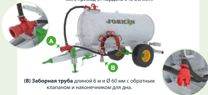
+ (А) Центробежный насос заполнения: подача 1 000 л/мин, привод от кардана 540 об/мин.
