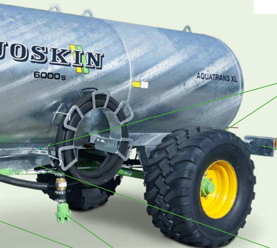
Tylne światła na zawiasach, które można ręcznie złożyć, aby zapobiec uszkodzeniu przez zwierzęta.
