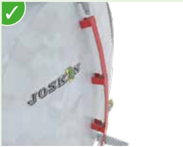
Beschermde niveaumeter , buiten bereik van de dieren.
