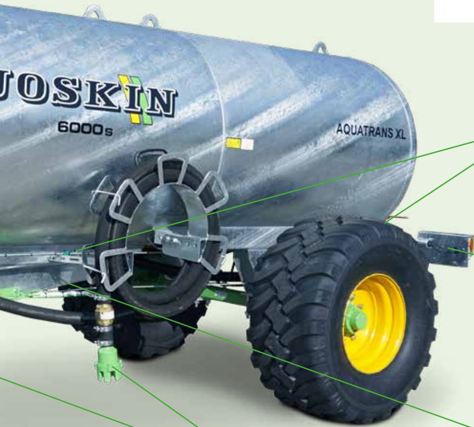
+ Faros traseros en bisagras que se pueden plegar manualmente para evitar daños causados por el ganado.
