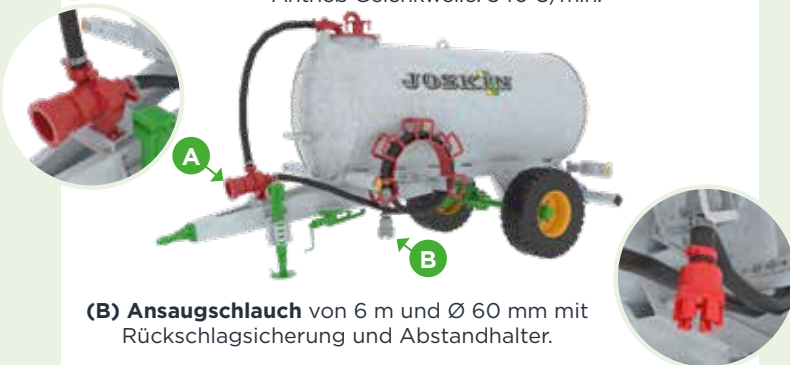
(A) Zentrifugalpumpe zum Befüllen: Durchfluss 1 000 l/min, Antrieb Gelenkwelle: 540 U/min.
