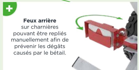
+ **Feux arrière** sur charnières pouvant être repliés manuellement afin de prévenir les dégâts causés par le bétail.
