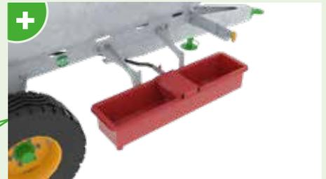
+ **Abreuvoir de 70 l à niveau constant** avec vanne 1" (pour fermeture au transport), en position arrière ou latérale.
