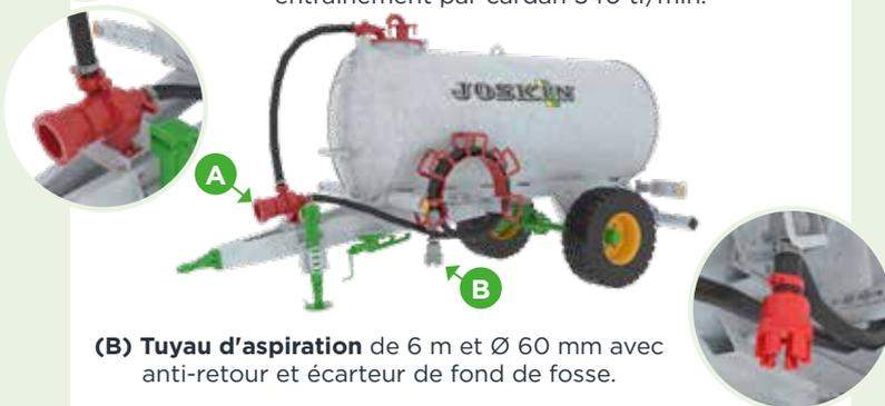
**(B) Tuyau d'aspiration** de 6 m et Ø 60 mm avec anti-retour et écarteur de fond de fosse.
