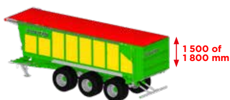
Cabriolé dekzeil (waterdicht) , zonder opzetschotten of met opzetschotten B neergelaten (onmogelijk om te zeilen met de opzetschotten omhoog).
