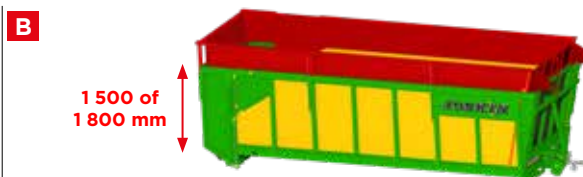
Hydraulische zij-opzetschotten van 50 tot 550 mm die individueel ingeschoven kunnen worden - handmatig opklapbaar voorschot - mechanisch achterdeel met 4 posities.
