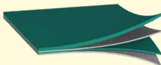
Structuur van de afvoerband: 4 lagen stof en PVC met nylon versterking, waarbij de onderste laag beter bestand is tegen wrijving.
