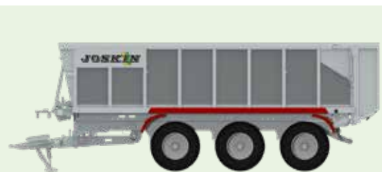
Spatborden: thermoplastisch voor-/achteraan en gegalvaniseerd aan de zijden.
