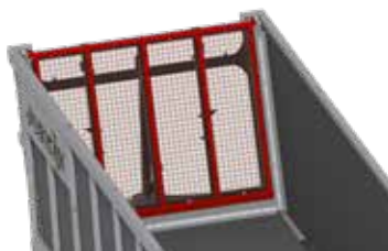
Grille betteravière pour protéger la face avant transparente des salissures.
