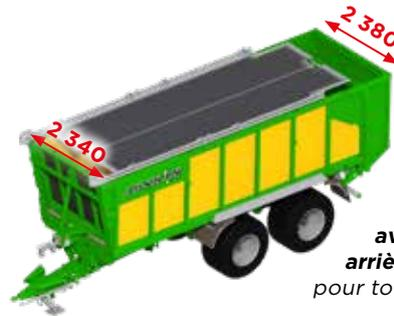
Caisse conique avec des largeurs intérieures avant (2 340 mm) et arrière (2 380 mm) identiques pour tous les modèles.
