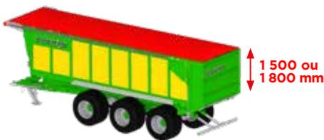
**Bâche type Cabriolé (étanche à l'eau)**, sans rehausses ou avec rehausses **B** abaissées (impossible de bâcher avec les rehausses relevées).
