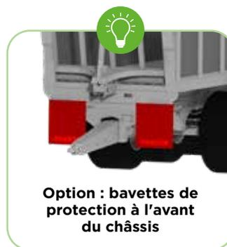
**Option : bavettes de protection à l'avant du châssis**
