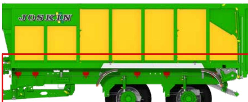
**2 châssis indépendants en tubes** avec 2x6 fixations pour une résistance parfaite.
