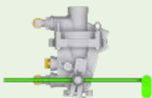
Frenos neumáticos proporcionales a la carga
