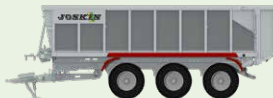
Guardabarros: delanteros/traseros de termoplástico y laterales de acero galvanizado.
