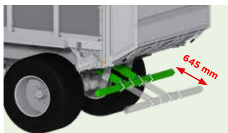
Parachoques replegable hidráulicamente
