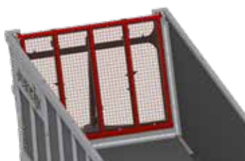
Rübenegitter zum Schutz der transparente Vorderseite vor Verschmutzung.
