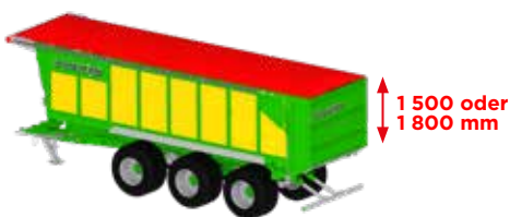
Plane Typ Cabriolé (wasserdicht) , ohne Aufsätze oder mit abgesenkten Aufsätzen B (bei angehobenen Aufsätzen kann die Plane nicht aufgerollt werden).
