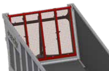
Rübenegitter zum Schutz der transparenten Vorderseite vor Verschmutzung.
