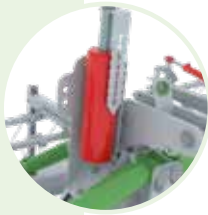
Variflex: Stufenlose hydraulische Einstellung der Zinkenaggressivität mittels mehrerer Ausgleichszylinder und eines oder zwei zentralen Zylinder mit Skala .
